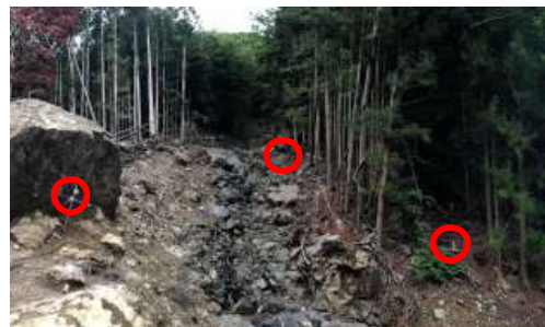
トンネル直上沢部 (傾斜計・伸縮計)
